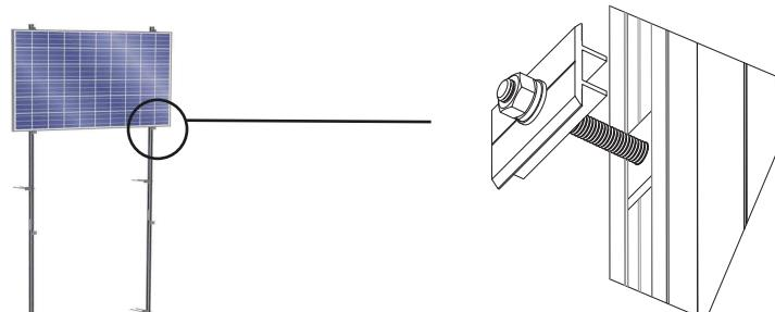
Sistema de fijación intermedia de módulos FV
