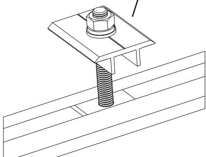
Sistema de fijación intermedia de módulos FV
