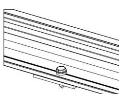
El sistema de estanqueidad está constituido por lámina de caucho EPDM adhesiva de 3mm de espesor ubicada entre la pieza de fijación y la chapa de cubierta. Los tornillos de fijación disponen de arandelas P14 y lámina de caucho para asegurar la estanqueidad.
