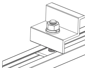
Sistema de fijación final de módulos FV
