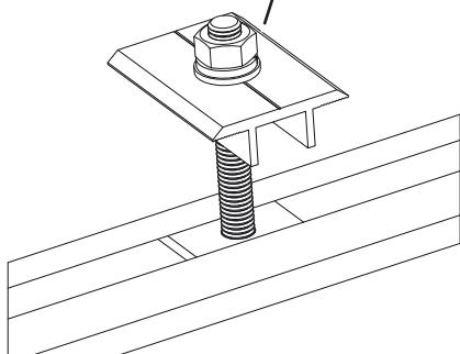
Sistema de fijación intermedia de módulos FV
