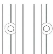
Colocación simétrica de tornillos
