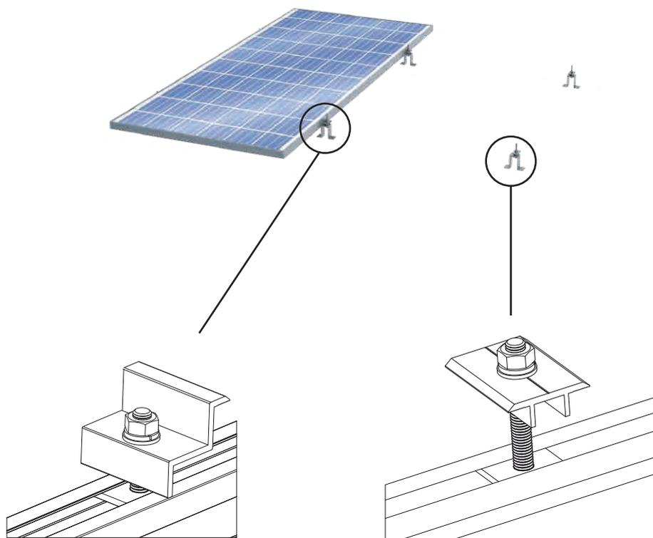
Sistema de fijación final de módulos FV
