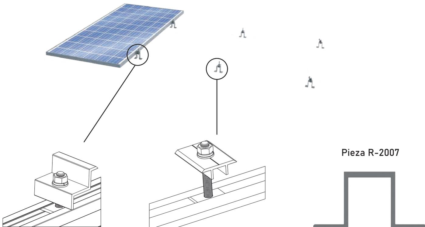
Sistema de fijación final de módulos FV
