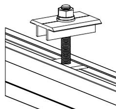
Sistema de fijación intermedia de módulos FV
