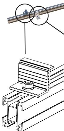
Sistema de fijación final de módulos FV
